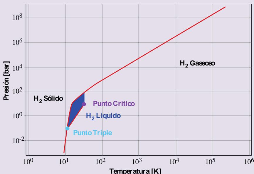
Figura 4. Diagrama de fases para el H<sub>2</sub>. El hidrógeno líquido sólo existe entre la línea sólida roja y la línea que conecta el punto triple y el punto crítico.
