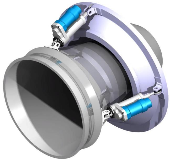
Fig. 6: Montaje de los actuadores
