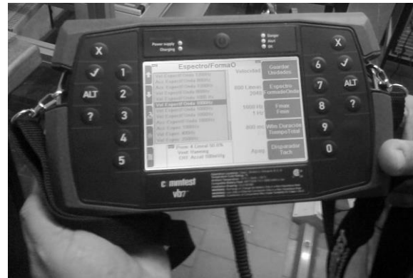
Fig. 2: Medidor de vibraciones COMTEST Vb7
