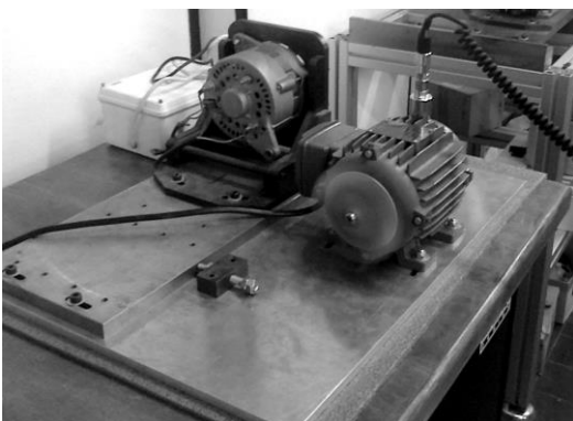
Fig. 1: Banco de ensayo con sensor de vibraciones.
