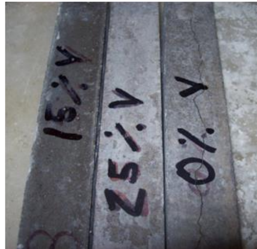
Fig. 5: Fisuras en probetas sin adición de vidrio luego del ensayo RAS
