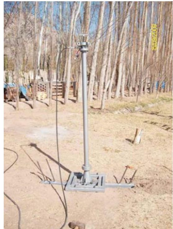
Fig. 5. Cañón de aire comprimido empleado en este trabajo como fuente de energización en este estudio. Gentileza del Lic. Armando Imhof.
