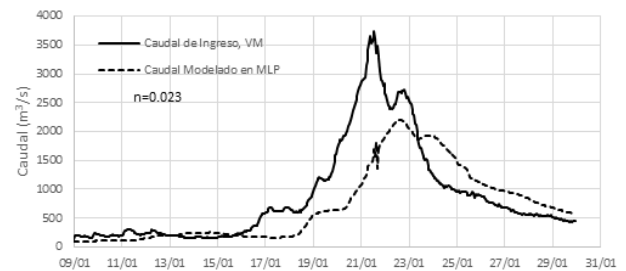
Fig. 9. Resultados de la modelación con vertedero lateral con MDT SRTM
