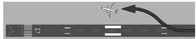
Fig. 7: Esquema de veer-off para despegue o aterrizaje. Fuente: elaboración propia.
