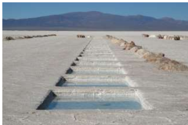
Fig. 3: Piletas de evaporación con salmueras ricas en litio en Salinas Grandes. (Foto: Ossian Lindholm).
