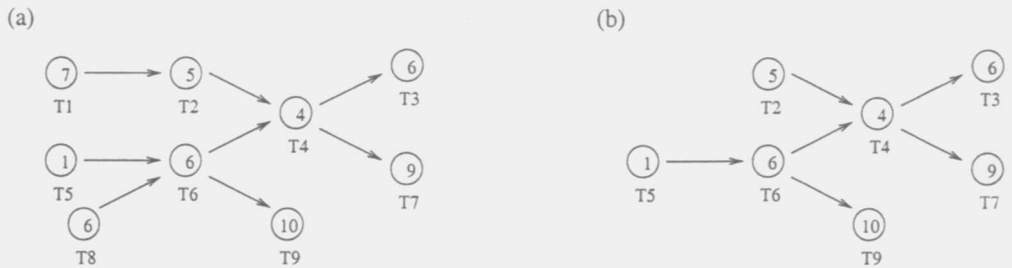
Figura 5: (a) Grafo de jerarquías original usado para generar una lista de prioridades con el método de los caminos críticos. (b) Grafo de jerarquías luego de haber borrado las dos primeras tareas seleccionadas.
