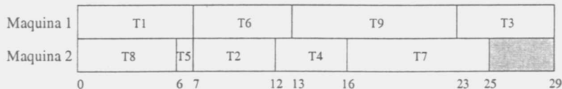
Figura 6: Horario obtenido a partir de la lista de prioridades producida por el método de los caminos críticos.
