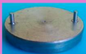
Caballote para pruebas de 60 mm de diámetro, y soportes cilíndricos de 10,5 mm altura y 3,2 mm diámetro
