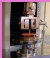
Máquina de ensayo y probeta sobre la que actúa el empujador
