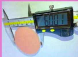
Probeta en resina acrílica 60x1 mm de diámetro
