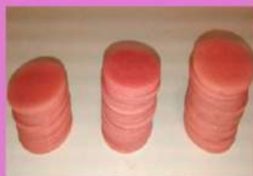
Grupo 1 Grupo 2 Grupo 3 Probetas en resina acrílica procesadas con 3 técnicas diferentes de curado
