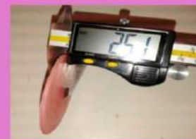
Probeta en resina acrílica 2.5 x 0.1 mm espesor
