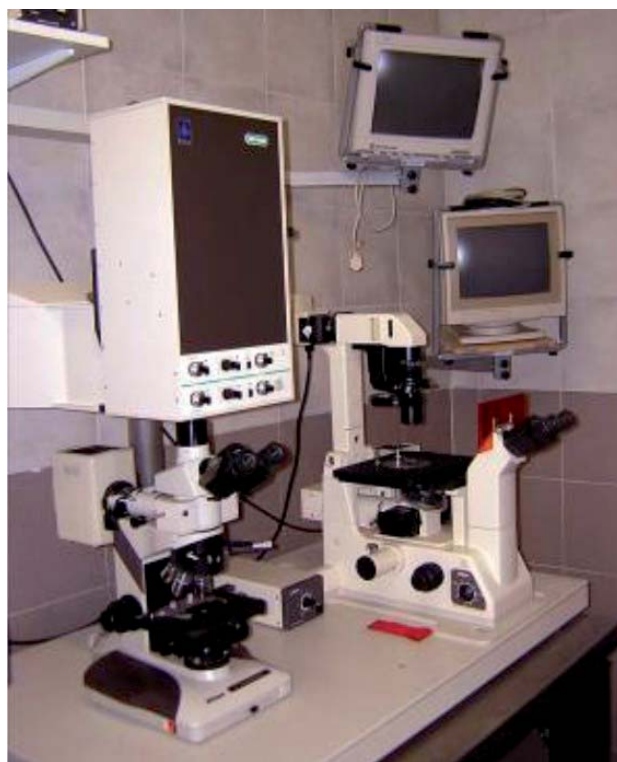
Figura 2. CLSM Biorad MRC 600 del Laboratorio de Procesamiento Láser dependiente del Centro de Investigaciones Ópticas (CIC/CONICET/UNLP) donde se realizaron los análisis.
