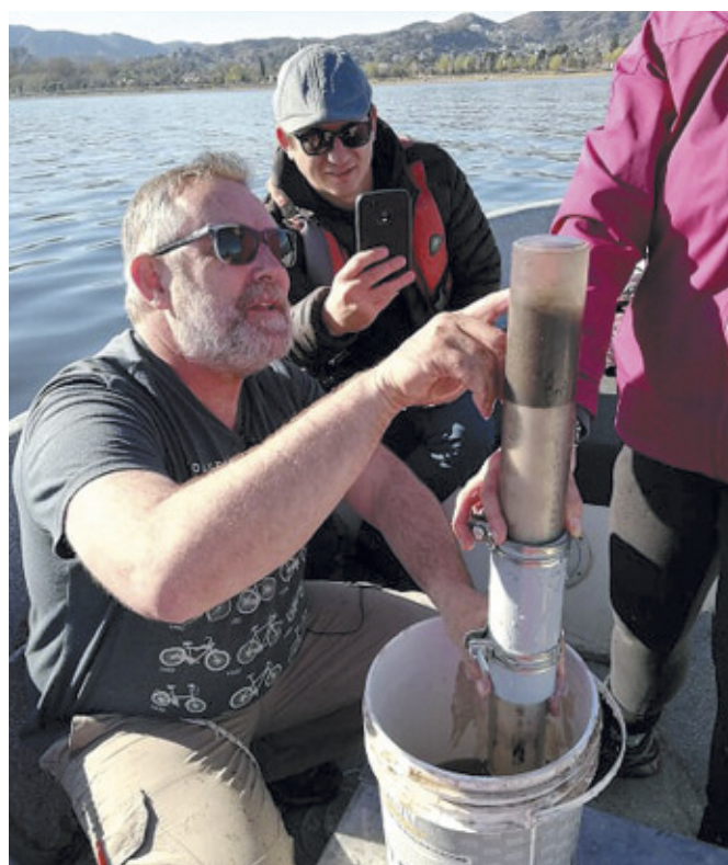
Figura 1. Desarrollando el meollo en el embalse San Roque: los sedimentos y la huella de la eutrofización. Muestreo de sedimentos del fondo del embalse San Roque utilizando un equipo especial para extraer núcleos o testigos sedimentarios. Autora: Nathalie Pussetto.
