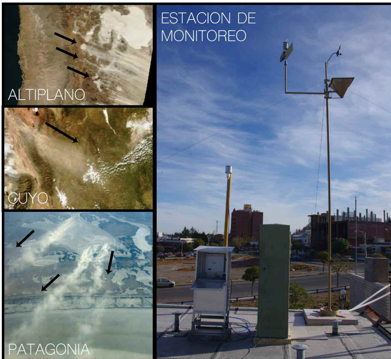
Figura 2. Tormentas de polvo en las principales zonas generadoras de aerosoles minerales en el sur de América del Sur, y captore pasivos utilizados para medir el flujo de polvo atmosférico. Imágenes satelitales tomadas de NASA WorldView ( http://worldview.earthdata.nasa.gov ).
