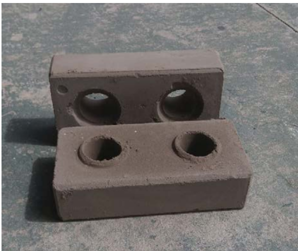
BTC fabricados por la empresa "Mobak", empleados en la construcción de la vivienda de Arroyo Leyes, Sta. Fe. colaboración del Ing. Santiago Cabrerá, UTN, Sta. Fe
