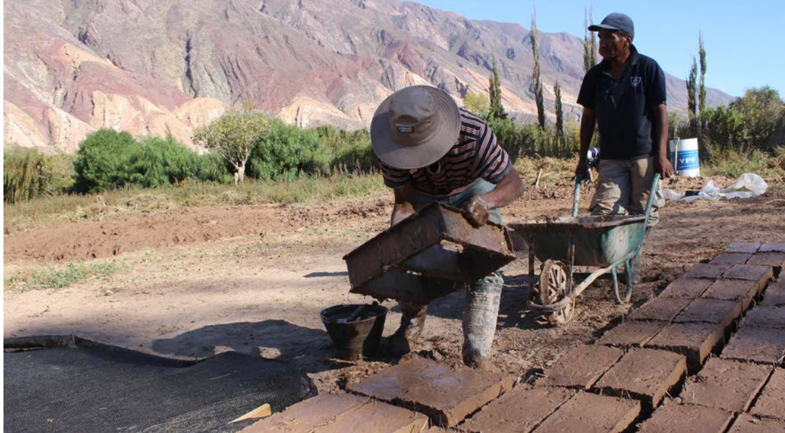
Proceso de fabricación de adobe en Jujuy
