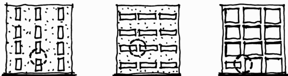
Muros con perforaciones que producen importantes concentraciones de tensiones en puntos determinados.
