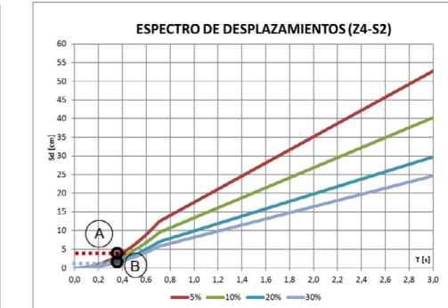
Influencia del amortiguamiento en la respuesta de desplazamientos
