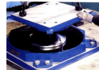
Montaje de un Péndulo de fricción.
