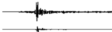
Residencia UTN - FRM. Registros de aceleraciones sísmicas Mendoza el 18/06/2012. Arriba: torre con base fija, abajo: torre aislada
