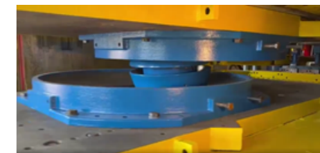
Ensayo de un Péndulo de fricción.
