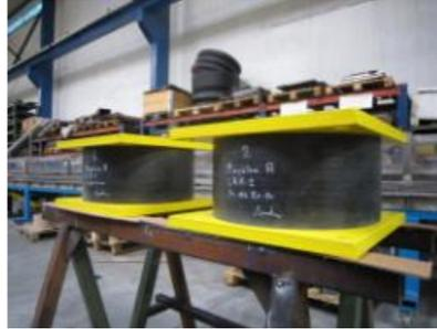
Aislador cilíndrico con placas cuadradas.
