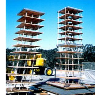
Ensayo en mesa vibradora a) Base Fija b) Base aislada (UCSD)
