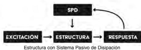
Estructura con Sistema Pasivo de Disipación
