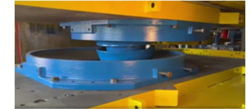
Ensayo de un Péndulo de fricción.
