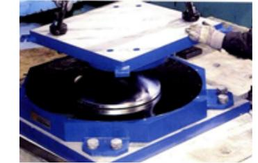
Montaje de un Péndulo de fricción.
