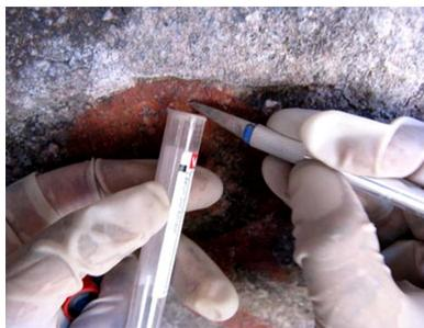
**Figura** – Detalle de la extracción de la muestra de pigmento y su rotulado.
