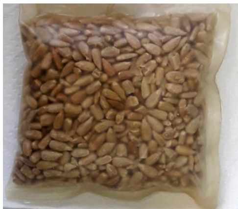
Figura 1. Bioenvase elaborado con harina de maní (HM) conteniendo a) aceite de girasol y b) granos de girasol.
