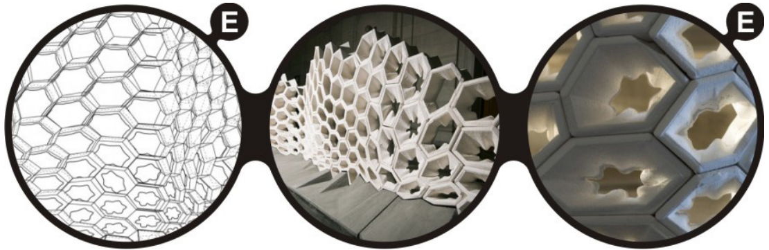
Fig. 10 (elaboración del autor): “Pinch wall” Arthur Azoulay, et. al., Pennsylvania, USA, 2009 - [sistema SUSTRACTIVO]
