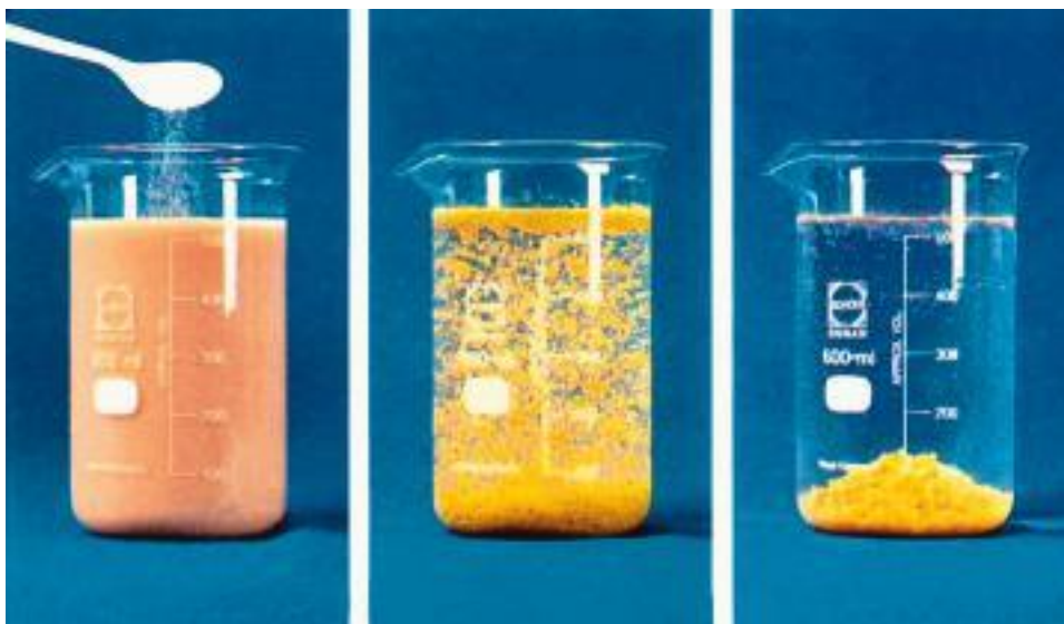
Figura 4: Experimentos de coagulación / floculación / sedimentación
