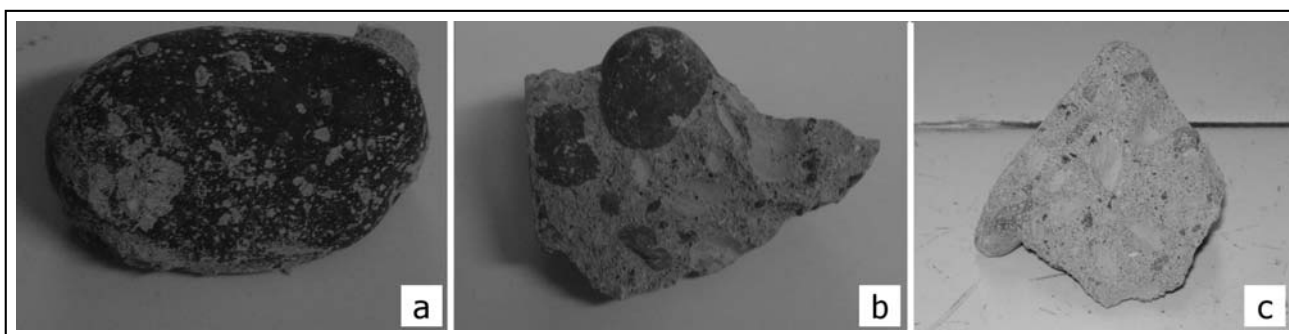
Figura 1. Partículas de agregado reciclado. a. Agregado natural. b. Canto rodado con mortero adherido. c. Mortero.
