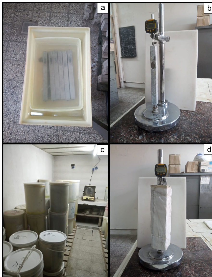
Figura 2. Preparación y medición de barras de mortero (a, b) y prismas de hormigón (c, d). a. Barras de mortero en solución 1N de NaOH. b. Medición de la expansión. c. Almacenamiento de prismas de hormigón en cámara húmeda a 38 °C. d. Medición de la expansión.
