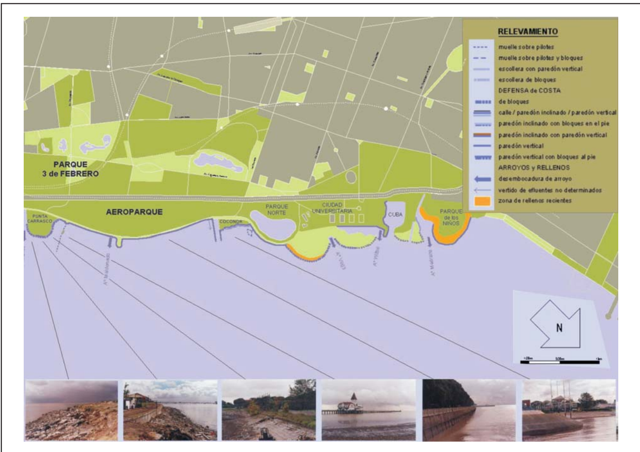
Figura 3B. Relevamiento y caracterización de las estructuras costeras del sector Norte de la Ciudad Autónoma de Buenos Aires.
