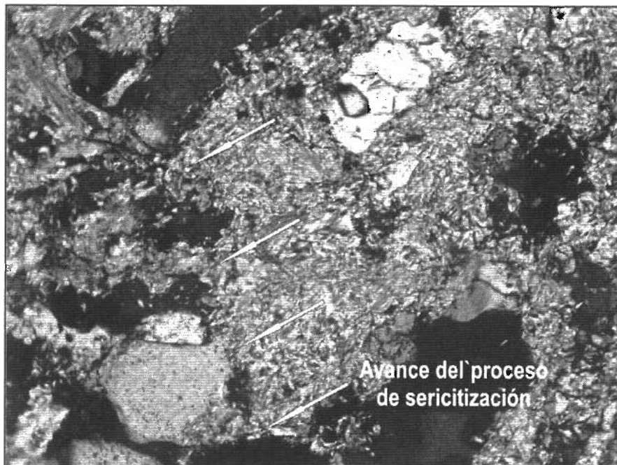
FIGURA 6. SERICITIZACIÓN Y FELDESPATIZACIÓN SECUNDARIA CASI TOTAL. Se observa crecimiento de muscovita, debido a lo avanzado del proceso sericítico (cristal más grande de Ms) y microfisuras vacías en el feldespato primario afectado
