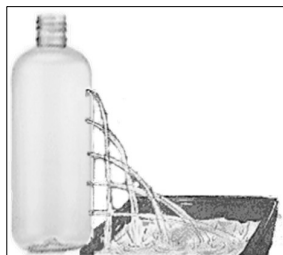
FIGURA 4. Comportamiento del agua saliente por los orificios de una botella realizados a diferentes alturas
