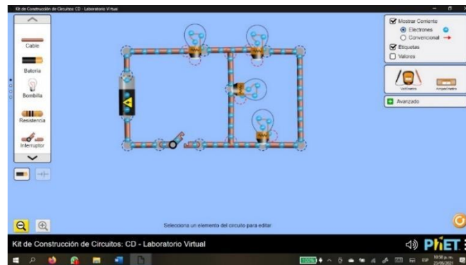
FIGURA 1. Laboratorio virtual desarrollado por la Universidad de Colorado. Kit de construcción de circuitos eléctricos de corriente continua, mediante el cual se pueden construir diversas configuraciones de circuitos y realizar la simulación computacional de su funcionamiento.
