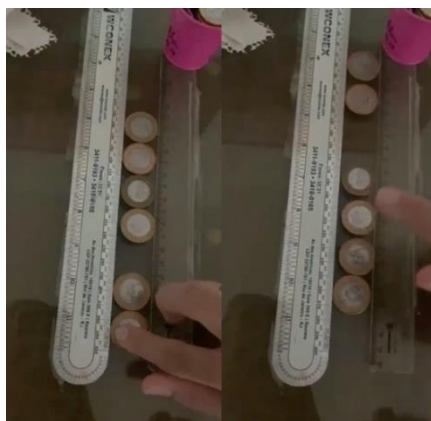
FIGURA 4. Pêndulo horizontal com o lançamento de duas moedas. Observe após o choque o deslocamento de duas moedas.
