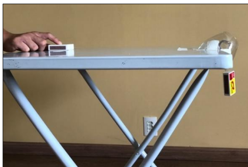
FIGURA 2. Montagem completa para o experimento acerca da segunda lei de Newton, desenvolvida na Atividade 1.
