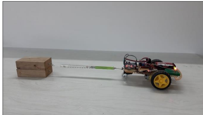
FIGURA 2. Foto que muestra el arreglo experimental que los estudiantes armaron. El robot impulsa una serie de bloques que generan roce contra la mesa. El dinamómetro mide la fuerza de tracción que realiza el robot.
