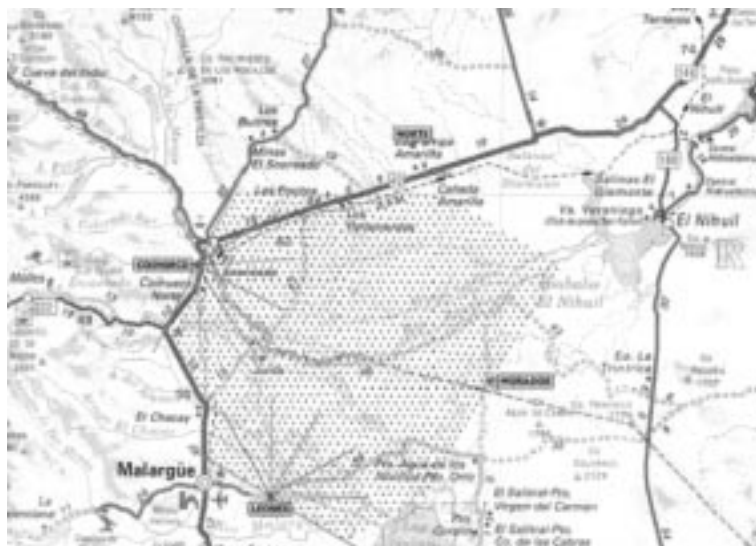
Figura 1: Observatorio Auger: los 1600 puntos indican detectores de superficie, separados 1,5 km entre sí. Los 4 edificios de telescopios de fluorescencia se encuentran en 4 elevaciones, denominadas Los Leones, Coihueco, Morados y Loma Amarilla. Las líneas en los edificios de fluorescencia indican los ángulos de visión de cada uno de los 6 telescopios.
