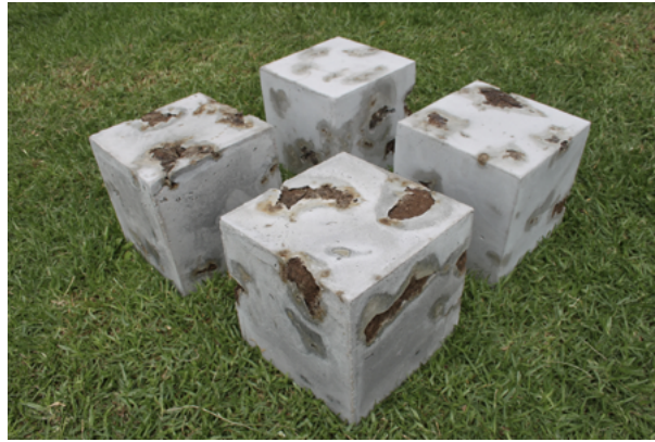
Figura 21. Cubos de concreto y estiércol.
