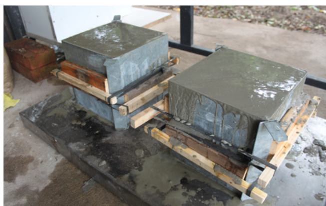
Figura 20. Moldes metálicos con tutores externos.
