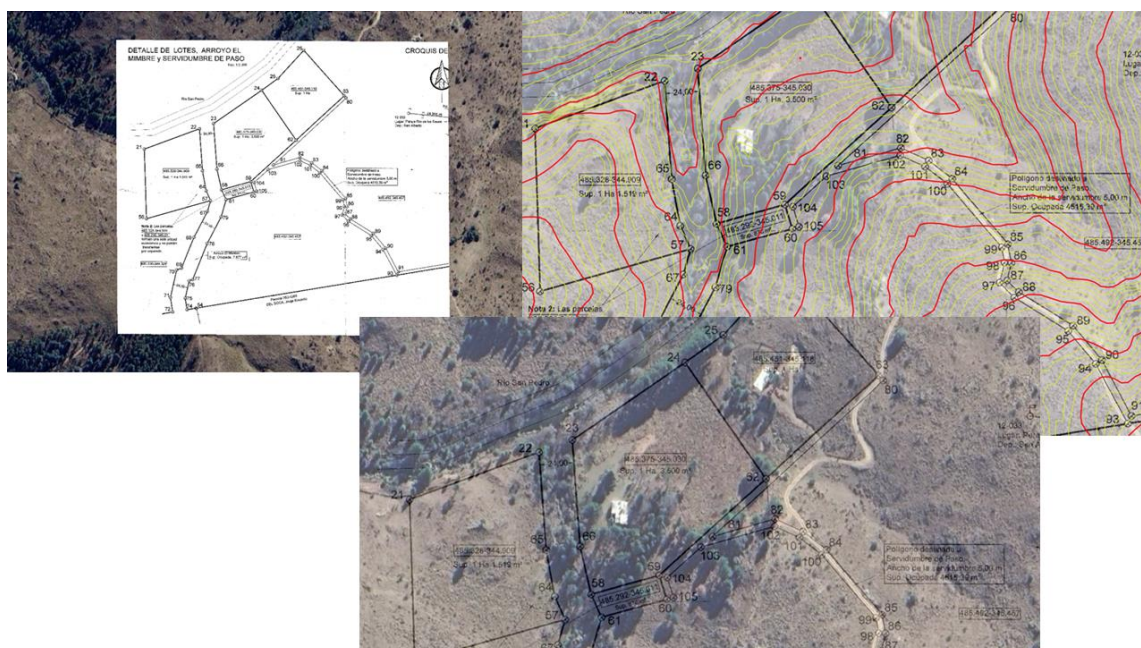
Figura 6 Georreferenciación de un plano de Mensura. Arriba izq: Plano de Mensura ubicado sobre foto satelital; der: Plano de Mensura y curvas de nivel sobre foto satelital; Abajo: Límites de propiedad sobre foto satelital.
